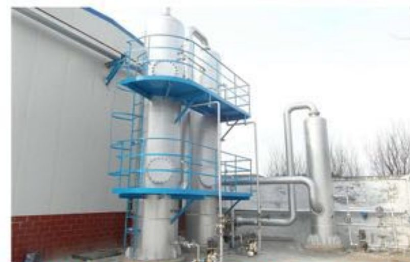
含DMAc VOCs废气双塔双级回收项目
